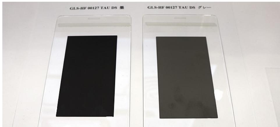
MRX-HF00127 TAU DS黑、灰、茶的印刷例（材料：PC）。因为这些可以多层印刷，所以可以利用屏蔽效果高的MRX-HF00127 TAU DS茶，追求屏蔽功能和设计性两个方面。
